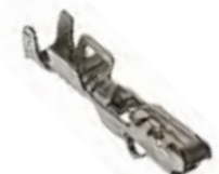
Terminal CINCH Fêmea Cód. 110093 Fio 0,50 à 1,00mm
